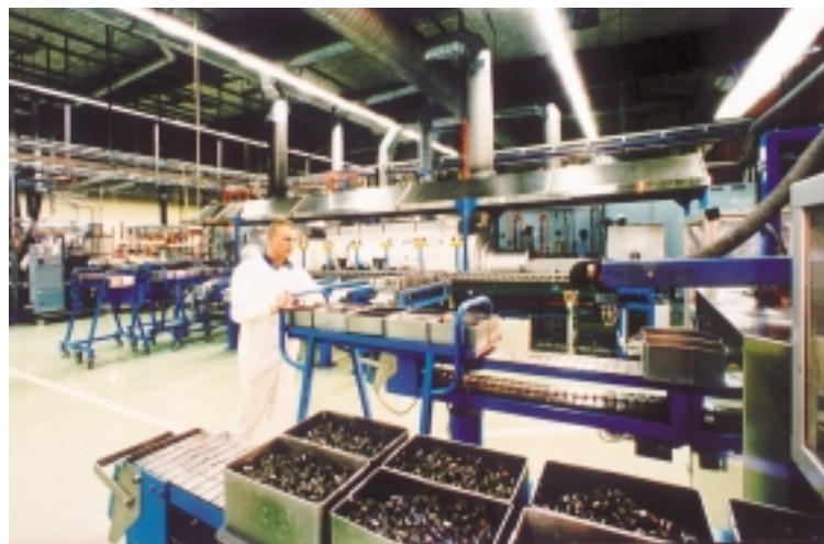
Pressning och sintring av urandioxidkutsar, foto ABB Atom
