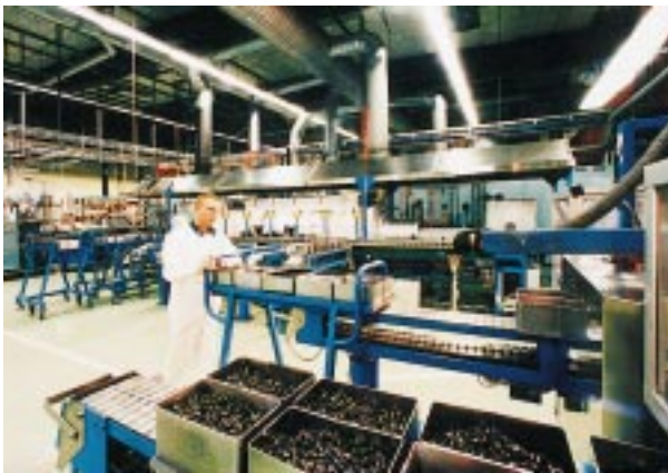
Pressning och sinkning av kutsar, lådor med kutsar i förgrunden (foto ABB Atom)
