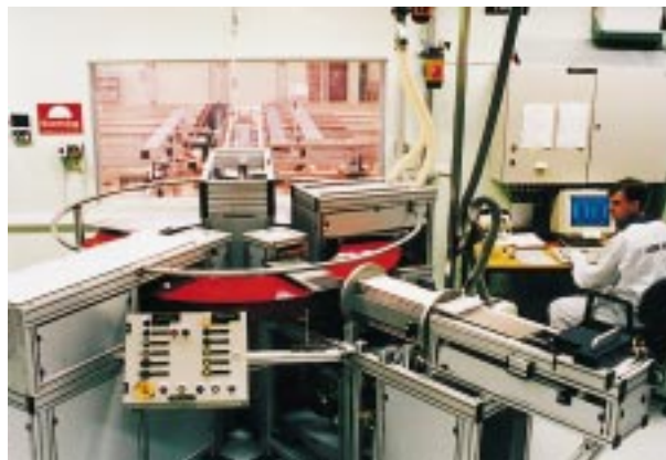
Urandioxidkutsar förs in i rör av zirkaloy (foto ABB Atom)
