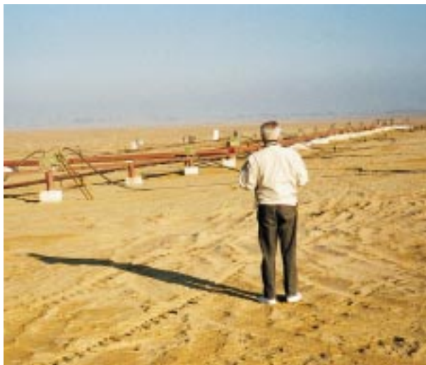
Rörssystem för In Situ Lakning
