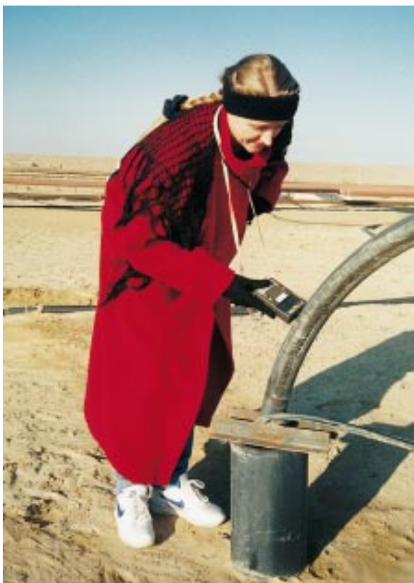
Agneta Rising mäter strålning vid slang med uranlösning
