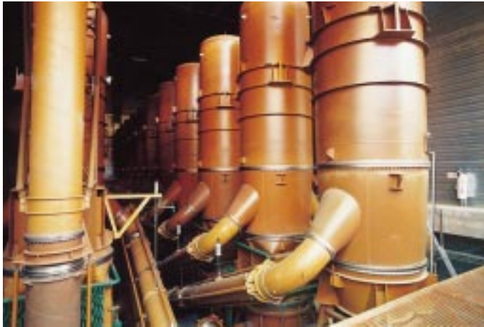
I dessa stora cylindrar - jämför mannen till höger - anrikas uranhexafluorid med gasdiffusion vid EUODIF i södra Frankrike.
