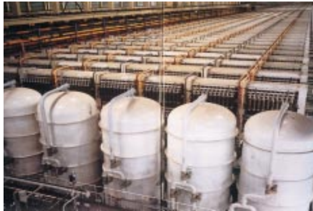
Hall med gascentrifuger i Zelenogorsk (de stora behållarna i förgrunden är ett säkerhetssystem som kan samla upp uranhexafluorid vid ett driftstopp).
