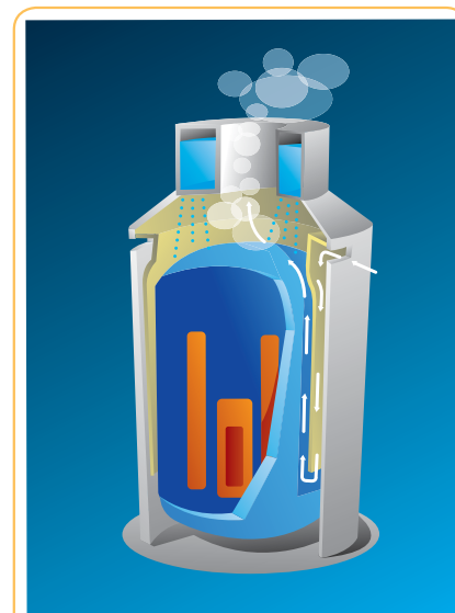
Bild 4. AP 1000 med passiv kylning av reaktorhärden.
